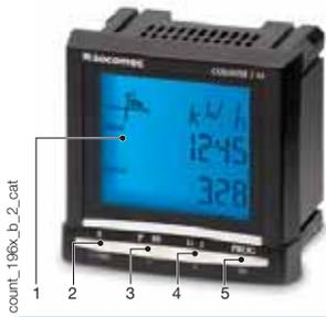
1. Afficheur LCD rétroéclairé
